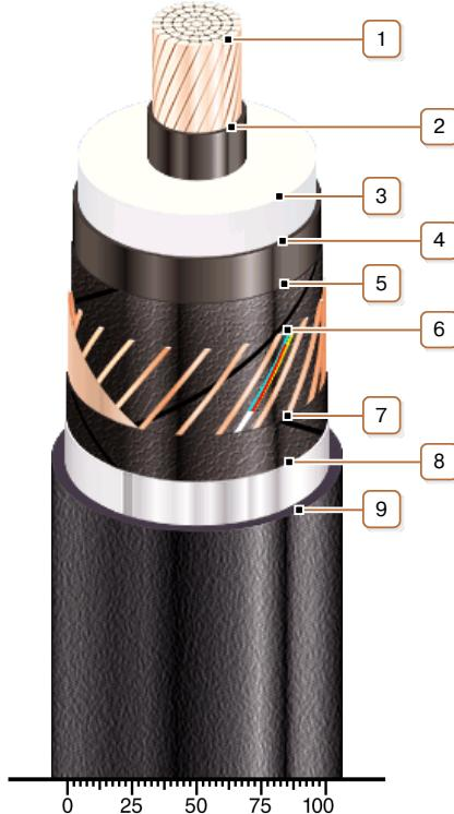
**1. Медная многопроволочная уплотненная токопроводящая жила**
