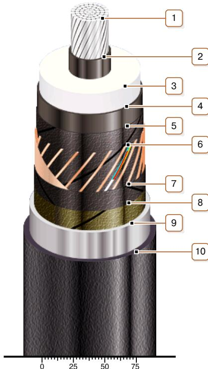
**КОНСТРУКЦИЯ****1. Алюминиевая многопроволочная уплотненная токопроводящая жила**
