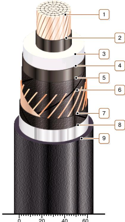
**1. Медная многопроволочная уплотненная токопроводящая жила**
