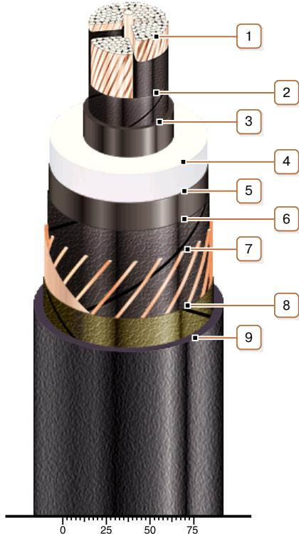
**1. Медная сегментная многопроволочная уплотненная токопроводящая жила**
