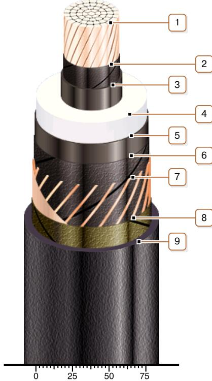
**1. Медная многопроволочная уплотненная токопроводящая жила**
