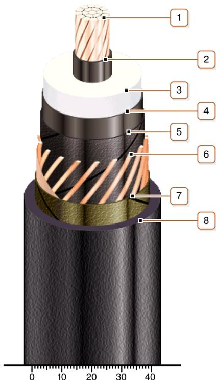
**1. Медная многопроволочная уплотненная токопроводящая жила**
