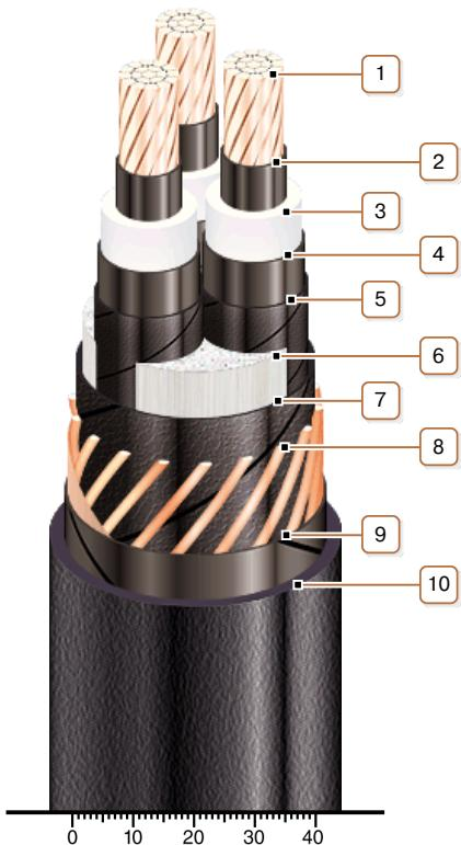
**1. Медная многопроволочная уплотненная токопроводящая жила**
